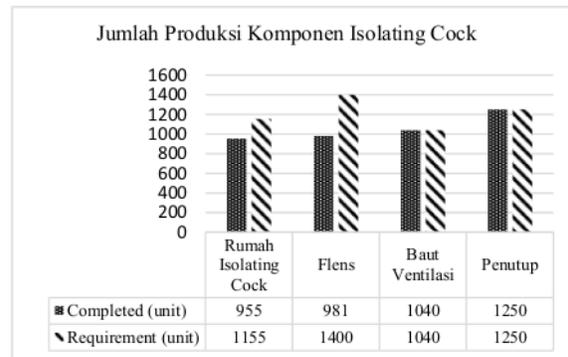
Gambar 24 Jumlah produksi komponen *Isolating Cock* untuk *order* PT INKA
